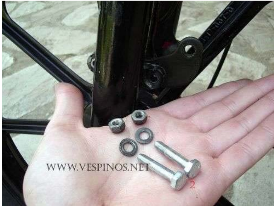
Tornillos (2) para sujetar la "L" (5)
