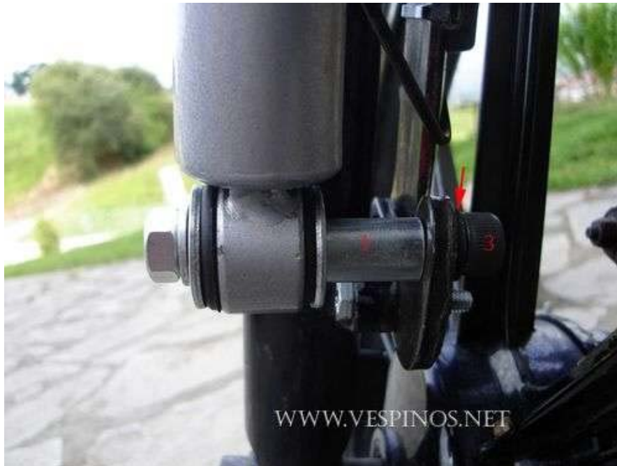
Detalle del inferior. La flecha roja indica una arandela opcional.
